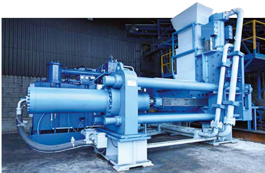
Die Recu 3 ist vor allem für flexible, dünne Metalle und Schrotte geeignet.
